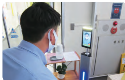
サーマルカメラ*の設置 ※非接触体表面温度測定機
