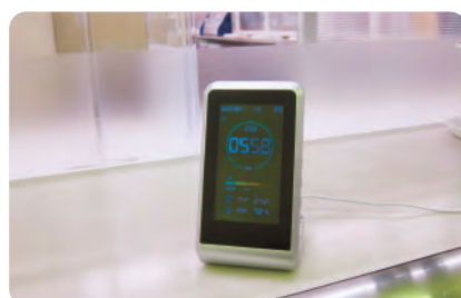
二酸化炭素濃度測定器の設置
